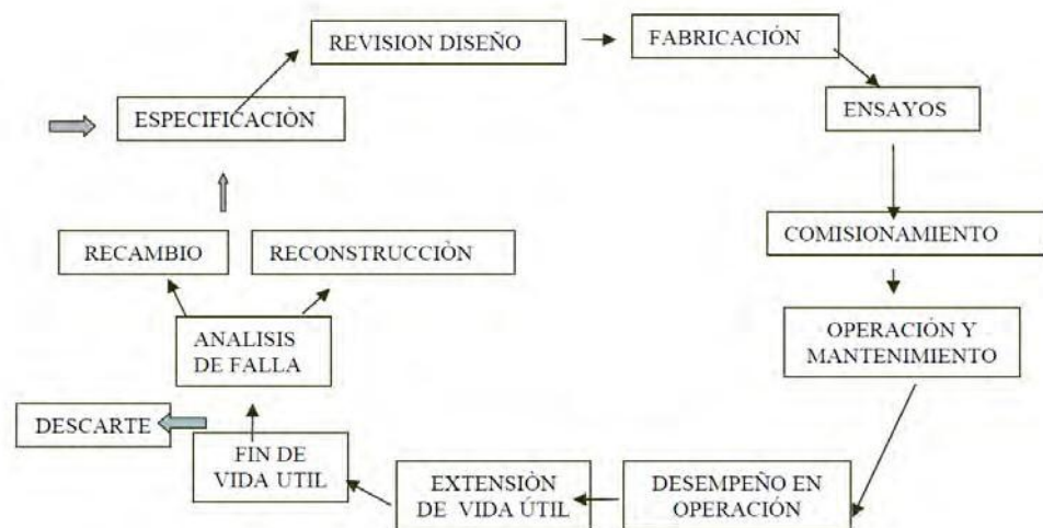
Figura 2.2 Ciclo de vida de un transformador de potencia
