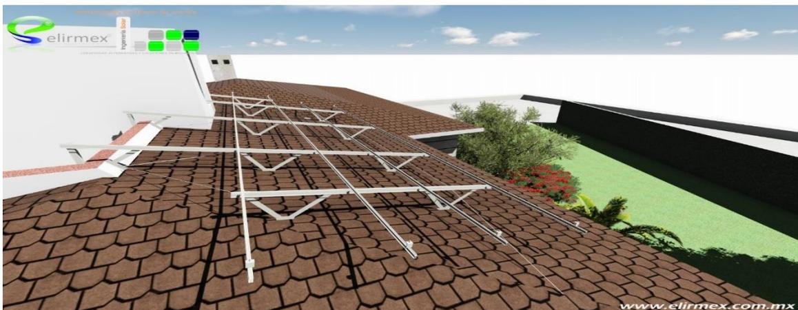
*Fig 3.1. Vista superior del montaje de la estructura.*
