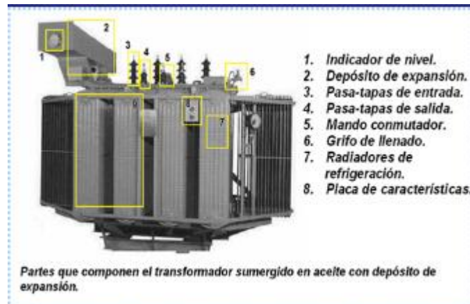
Fig. 11 ejemplo de transformador sumergido en aceite.
