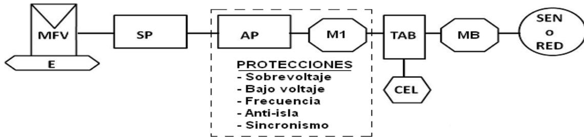
Figura 5 Diagrama de bloques de un SFIR.
