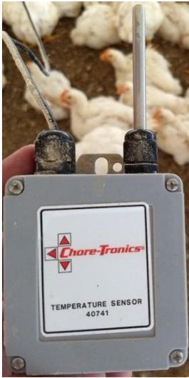
Figura 48 Sensor de temperatura.
