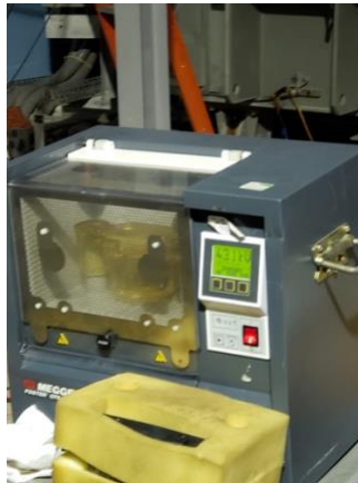
Imagen 29 - Prueba de rompimiento de aislamiento del aceite de los transformadores.
