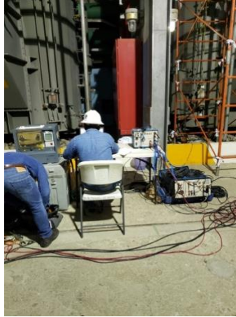
Imagen 28 - Prueba de resonancia inductiva para devanados de cada transformador del banco del generador síncrono no. 8.
