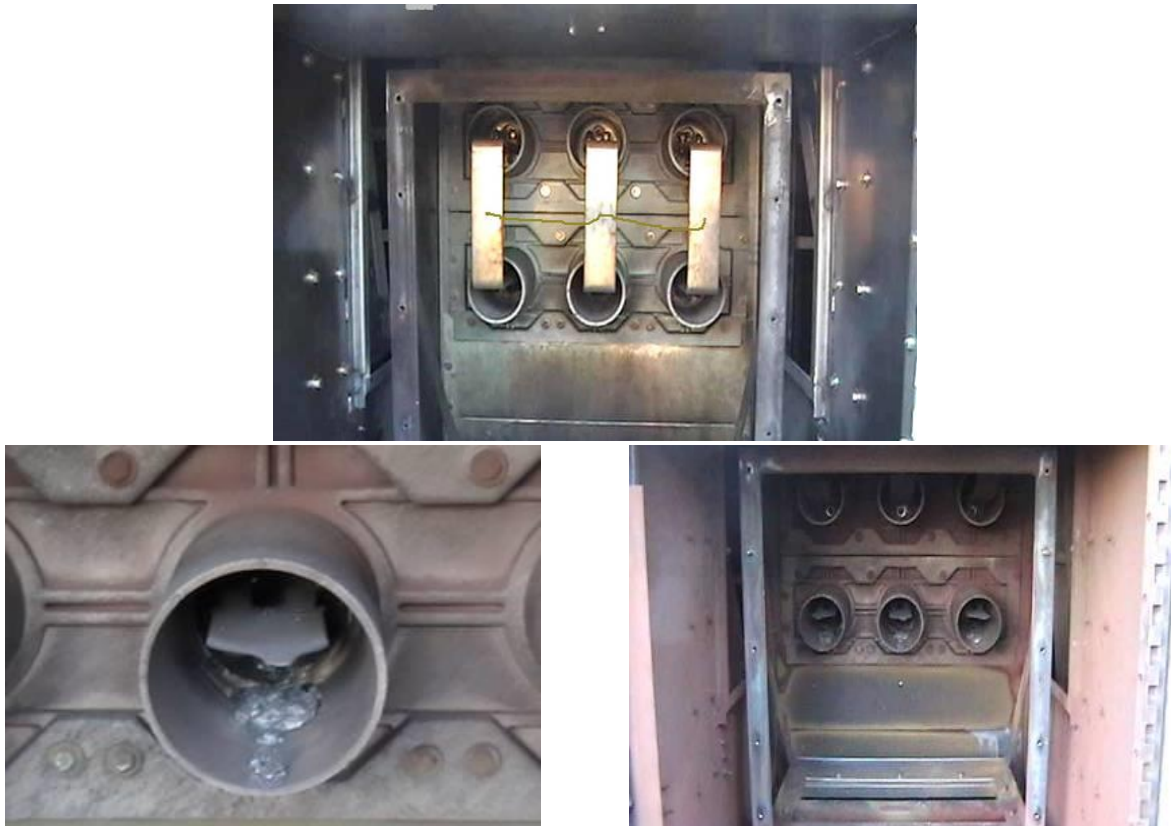
Fig. 2.15 Pruebas de arco eléctrico de 50kA a 500 ms sin protección de arco.
