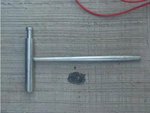
Este elemento es conocido como pica, cada pica tiene conectado una terminal del megómetro mediante cable banana-caimán como se muestra en la siguiente imagen
