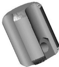
**Fig. 2.18** – *Aislador tipo tensor.*
