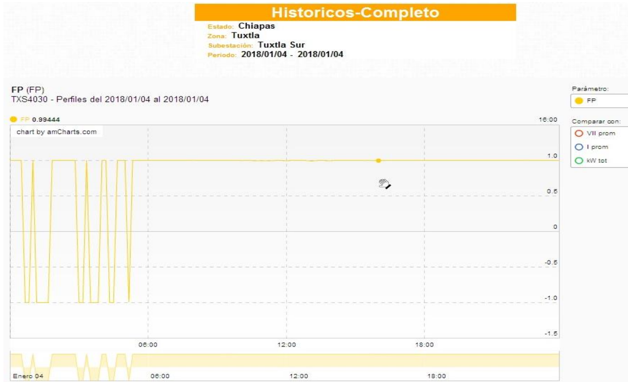
Figura 3.7.- Grafica de factor de potencia, del circuito TXS-4030.
