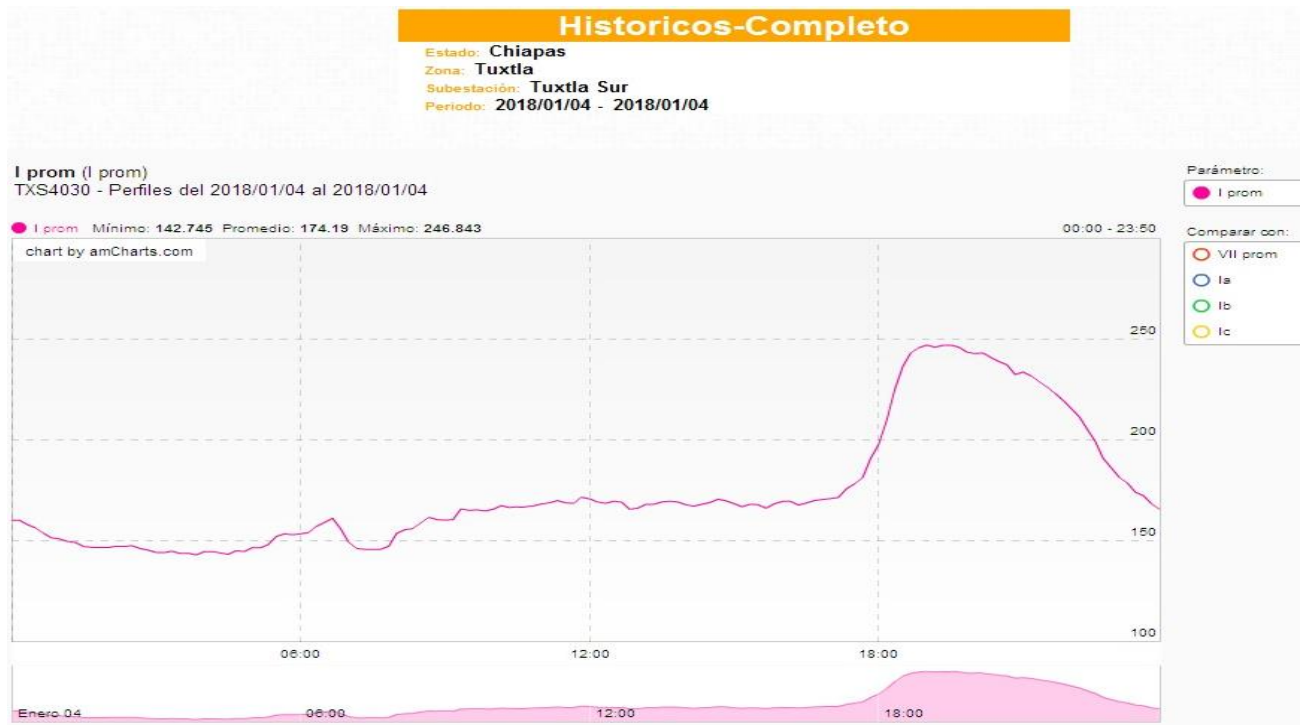
Figura 3.5.- Grafica de corriente promedio del circuito TXS-4030.
