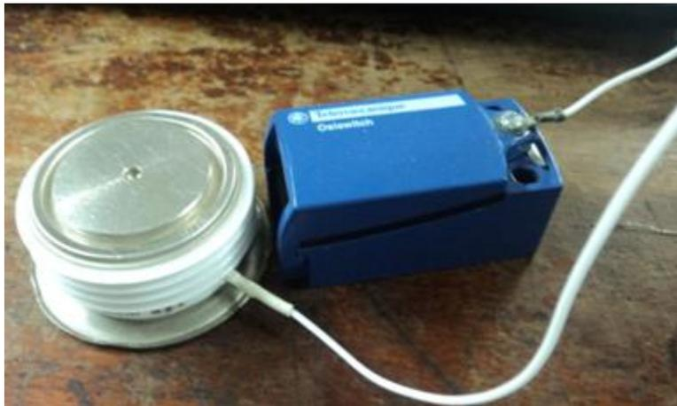
Figura 20: Tiristor SCR Modelo
