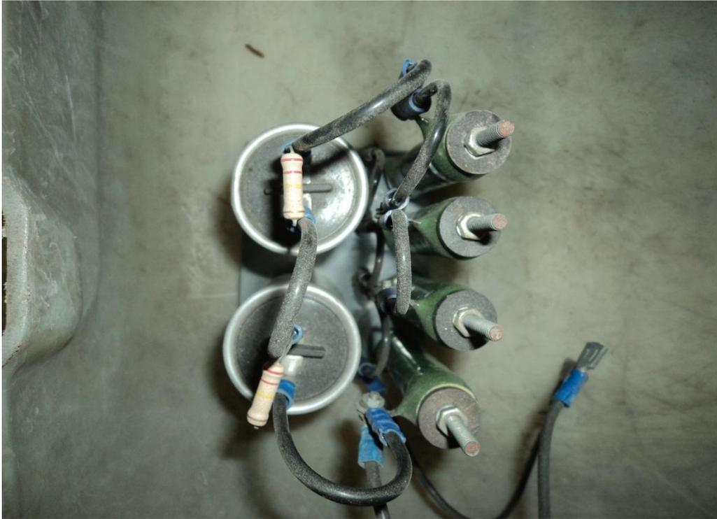
Figura 35: Verificación de los circuitos rc's.
