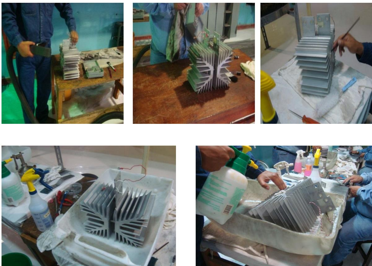
Figuras 42, 43, 44, 45 y 46: Mantenimiento y limpieza a las partes de banco.
