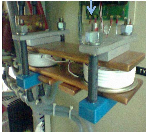
Figuras 38, 39, 40 y 41: Desmontaje del banco de tiristores.
