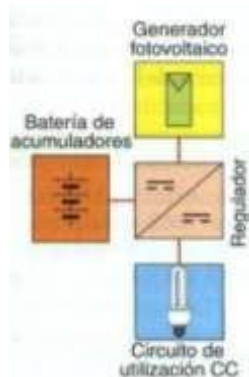
Imag.55. Sistema fotovoltaico con regulador y acumulador
