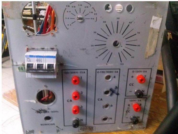
*Figura 21. Fuente trifásica del laboratorio de ingeniería eléctrica.*
