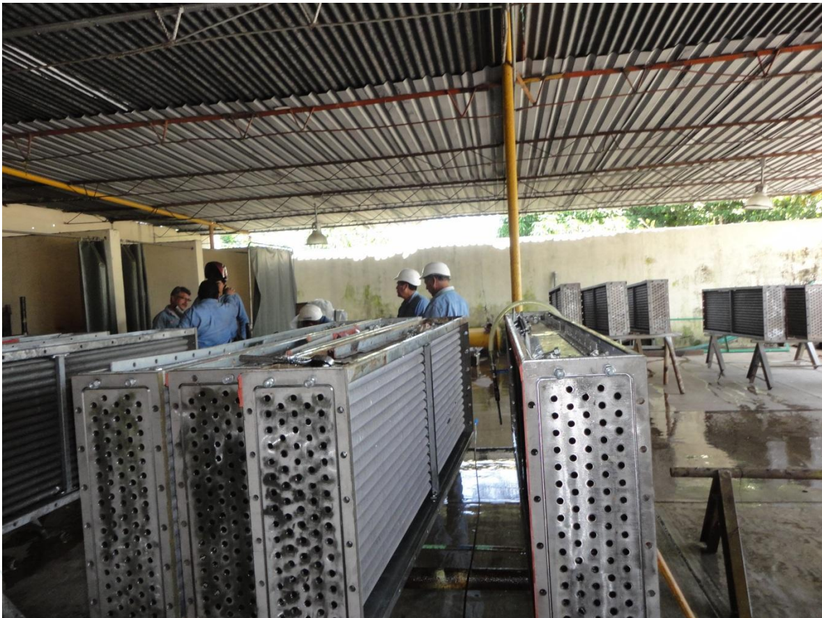
Figura 3.3.1.2 Fotografía de los ductos internos del radiados
