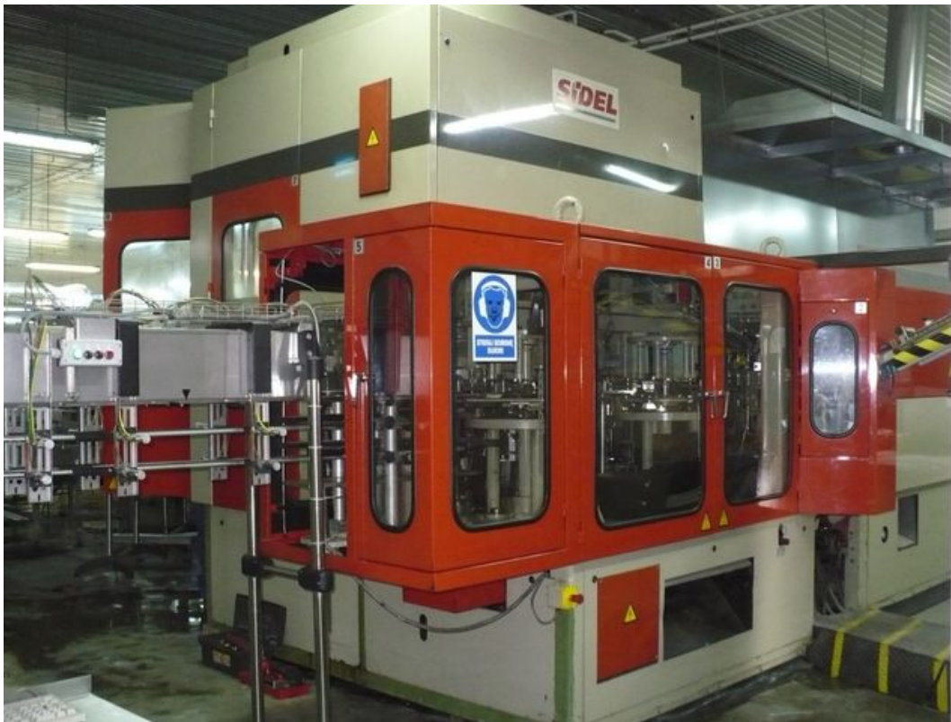
Figura 3.7 Máquina Sopladora de 12 moldes marca Sidel.
