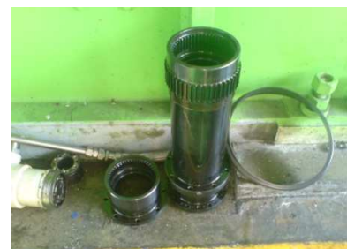
Figura 3.12 Eje de interconexión de entrada de compresores de alta y media presión
