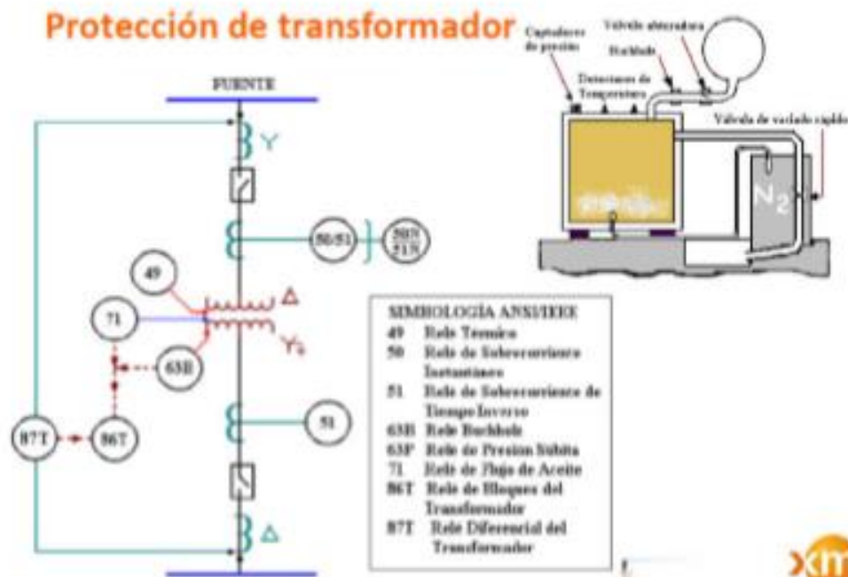
Fig. 16 Protección del transformador de potencia
