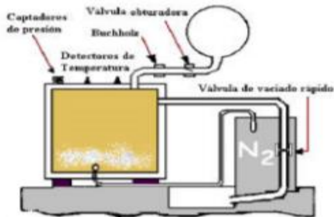
Fig. 20 Relés mecánicos en el transformador.
