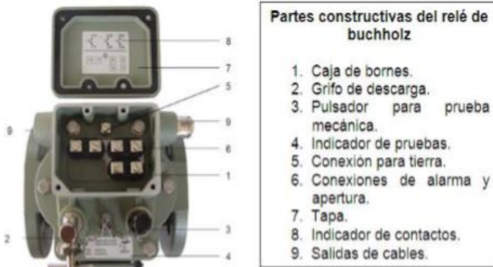
Fig. 7 Partes constructivas del relé Buchholz.
