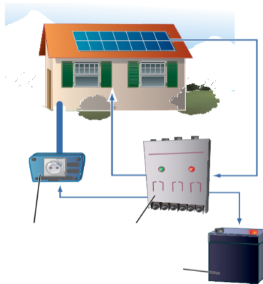
figura 2 instalación fotovoltaica autónoma
