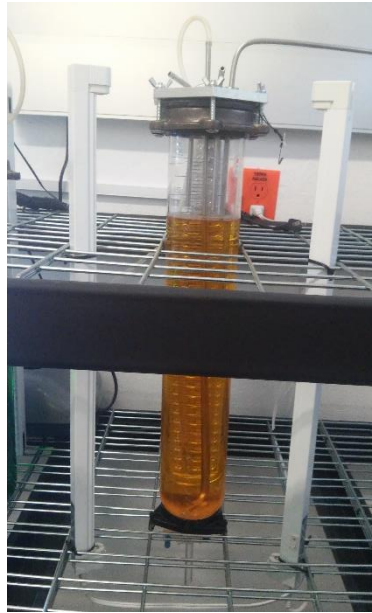
Figura 6.8 Termino del montaje del biorreactor.
