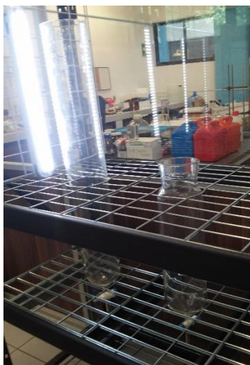
Figura 6.2 Ensamble de biorreactores a la base.
