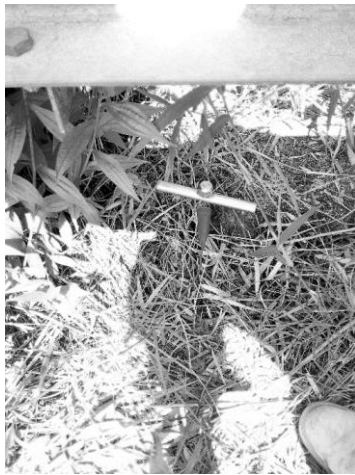
Fig. 3.10 Estaca de lectura del equipo de resistencia del suelo.
