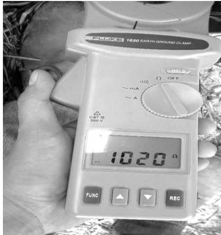
Fig. 3.15 Lectura Pata 1 de la estructura.
