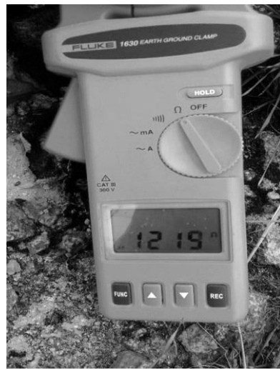
Fig. 3.18 Lectura Pata 4 de la estructura.
