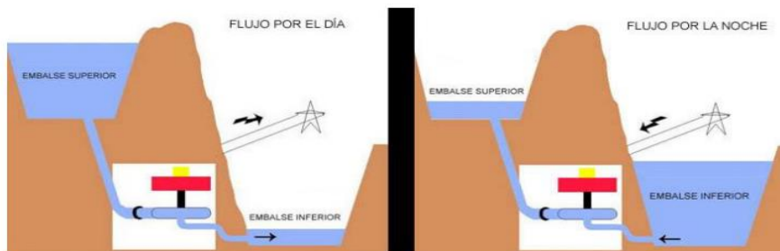
Figura 2.9 Central Hidroeléctrica de Bombeo
