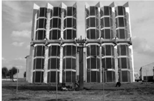
Figura 5.48 Seguidores de doble concentración.
