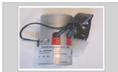
Figura. 7 a) 2nd generación de sensores de densidad.
