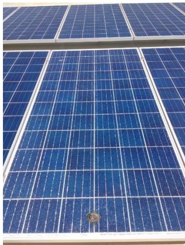
*Fig. 3.18 Módulo reventado y quemado por falla de sobre corriente en CC.*
