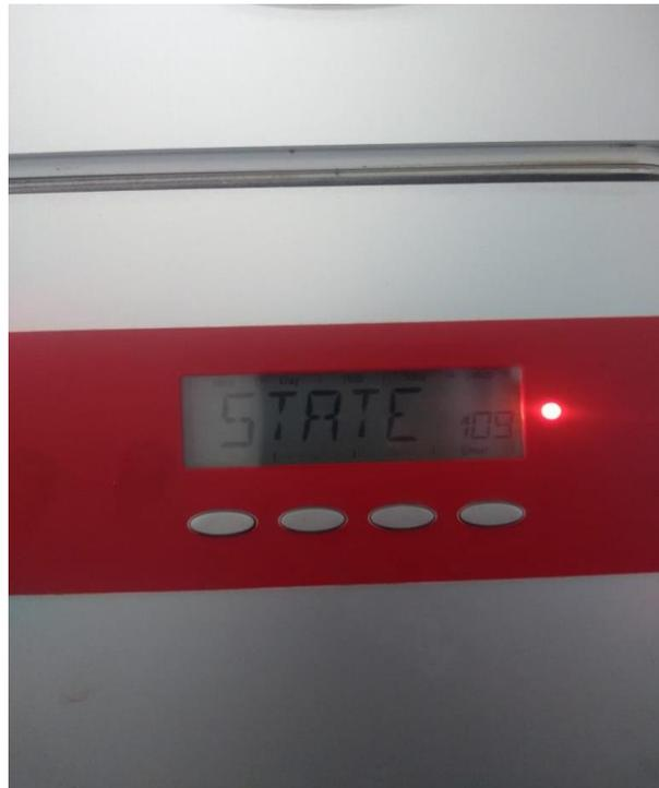
**Fig. 3.19** Interfaz marcando un error entre fases del sistema en CA.
