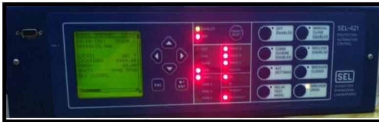
**Fig.4.1** Prueba al relevador con una falla trifásica al 60% de la línea.
