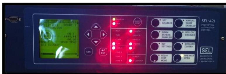
**Fig.4.5** Prueba al relevador con una falla trifásica al 60% de la línea
