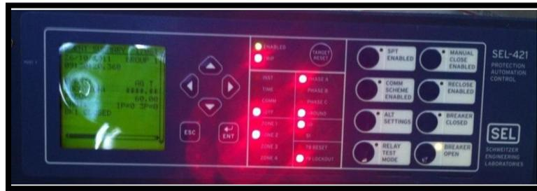
**Fig.4.6** Prueba al relevador con una falla trifásica al 135% de la línea
