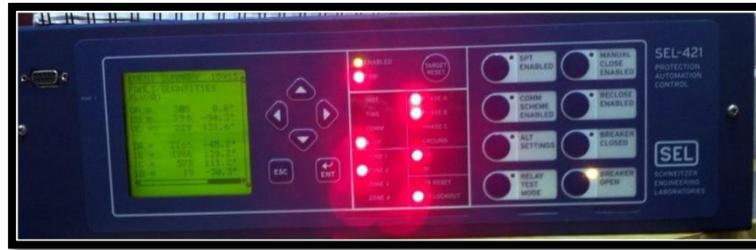
**Fig.4.4** Prueba al relevador con una falla trifásica al 135% de la línea.
