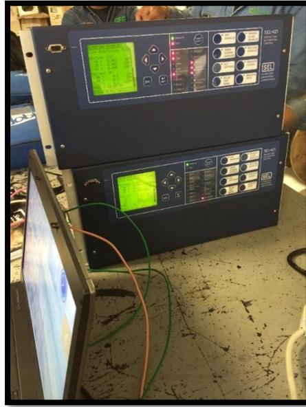
**Fig.3.9** Relevador SEL421 energizado con corrientes y voltajes de prueba.
