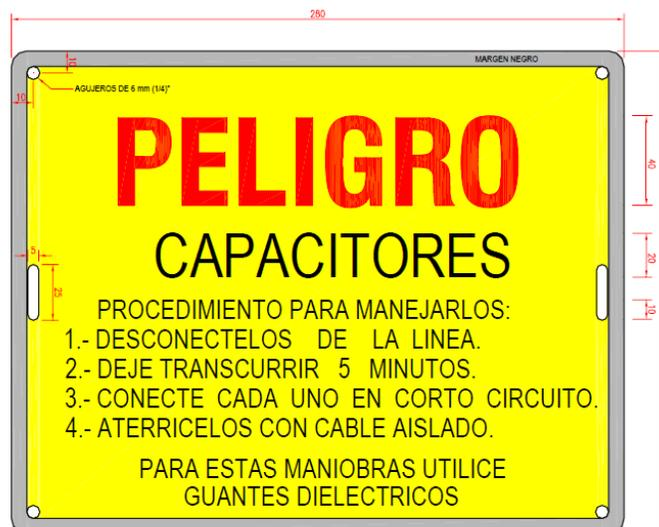
*Fig.2.34. SEÑAL DE SEGURIDAD PARA BANCOS DE CAPACITORES*
