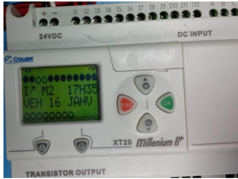
Fig. 3. 20 PLC detectando las entradas correspondientes a N1 y N2.
