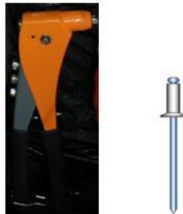
Fig. 3. 6 Remache y remachadora utilizada para la fijación del riel din y la platina.
