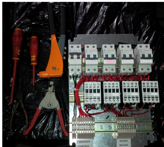
Fig. 3. 11 Cableado de cuadro eléctrico.
