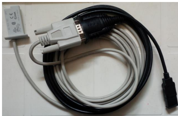
Fig. 2. 7 Cable de transferencia del PLC.
