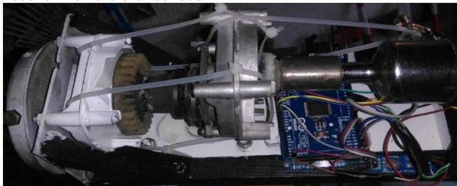
Teniendo los componentes de generación instalados se procedió a seleccionar los elementos de control, los cuales estarían ubicados en el buje del aerogenerador y en la nacelle.
