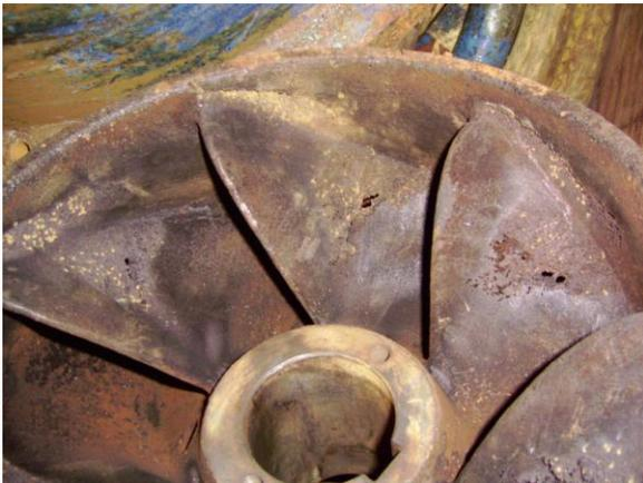
Figura 31. Impulsor de agua Potable en malas condiciones.
