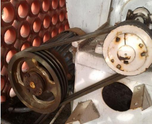
Fig. 21 Bandas De Transmisión
