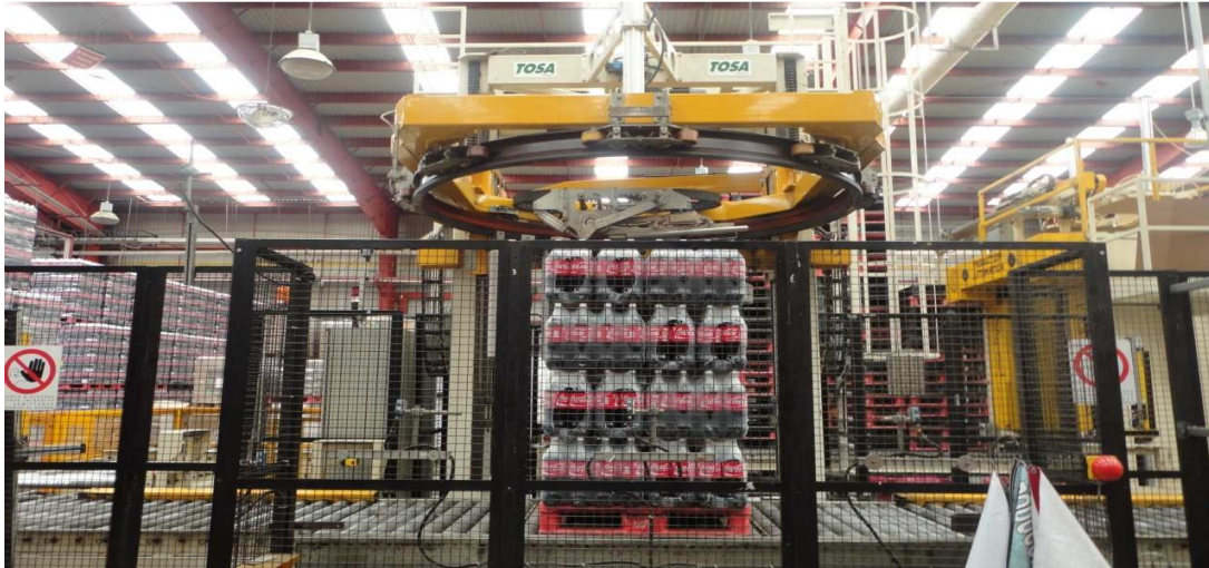
Figura 8) La emplayadora es una máquina que tiene la finalidad de envolver la tarima con películas de plástico para evitar caída de paquetes, esto lo hace colocando la película en tres secciones las cuales son en la parte superior, centro e inferior, en cada sección 2 vueltas.
