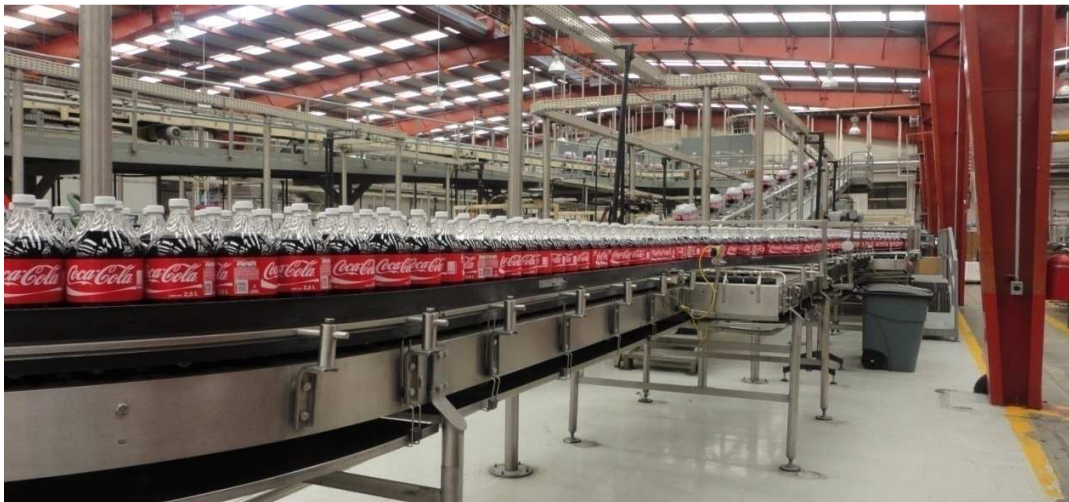
Figura 9) Los transportadores llevan los productos por toda la línea desde la llenadora hasta la paletizadora pudiéndose ajustar el ancho para la presentación del producto.
