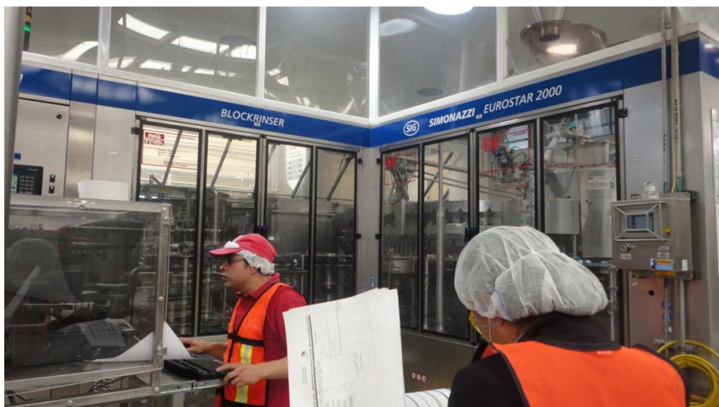
Figura 1) La llenadora es de marca SIMONAZZI con una capacidad de 12,000 BPH (Botellas Por Hora) en presentaciones de 3 litros.
