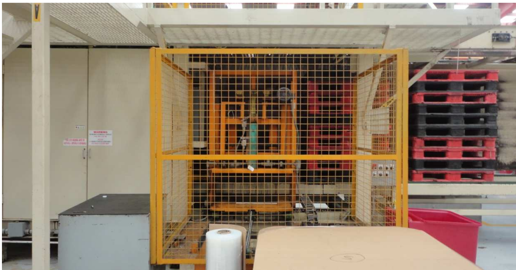
Figura 7) La paletizadora marca PAI es una máquina que cumple la función de armar las tarimas de paquetes de 4 productos en el caso de 3 litros y deslizarlos hacia la emplayadora.
