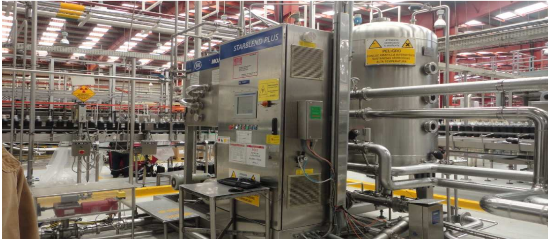
Figura 2) El mezclador es de la marca FILTEC que tiene como finalidad mezclar el jarabe, agua y CO 2 a la norma y relaciones establecidas, para el consumo humano.
