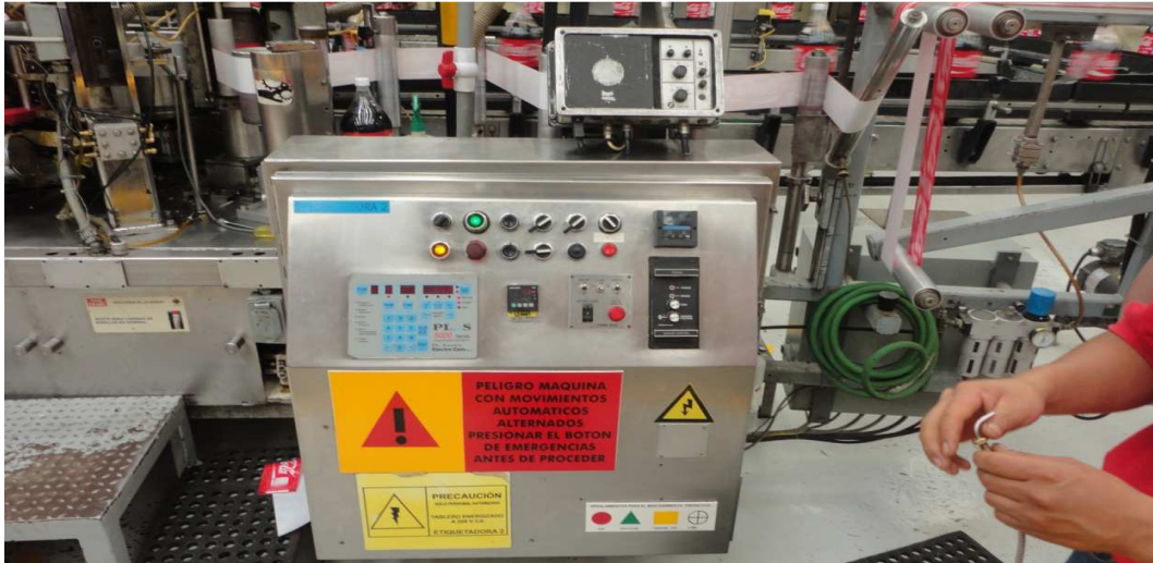
Figura 4) La etiquetadora numero 1 de la marca TRINE modelo 6700 coloca la etiqueta a cada una de las presentaciones con una capacidad de 6,000 BTH en 3 litros.
