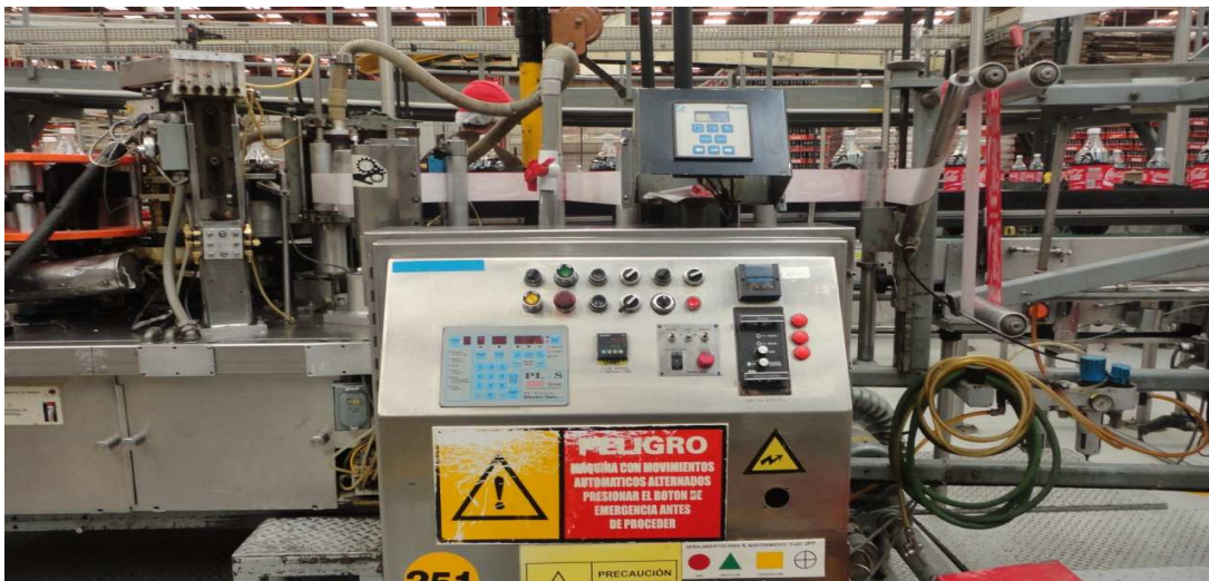
Figura 5) Al igual que la etiquetadora numero 1 tiene la finalidad de colocar la etiqueta para la presentación deseada, en la presentación de 3 litros tiene la misma capacidad que la etiquetadora número 1 que son 6,000 BTH cumpliendo con un total de 12,000 BPH entre las dos .
