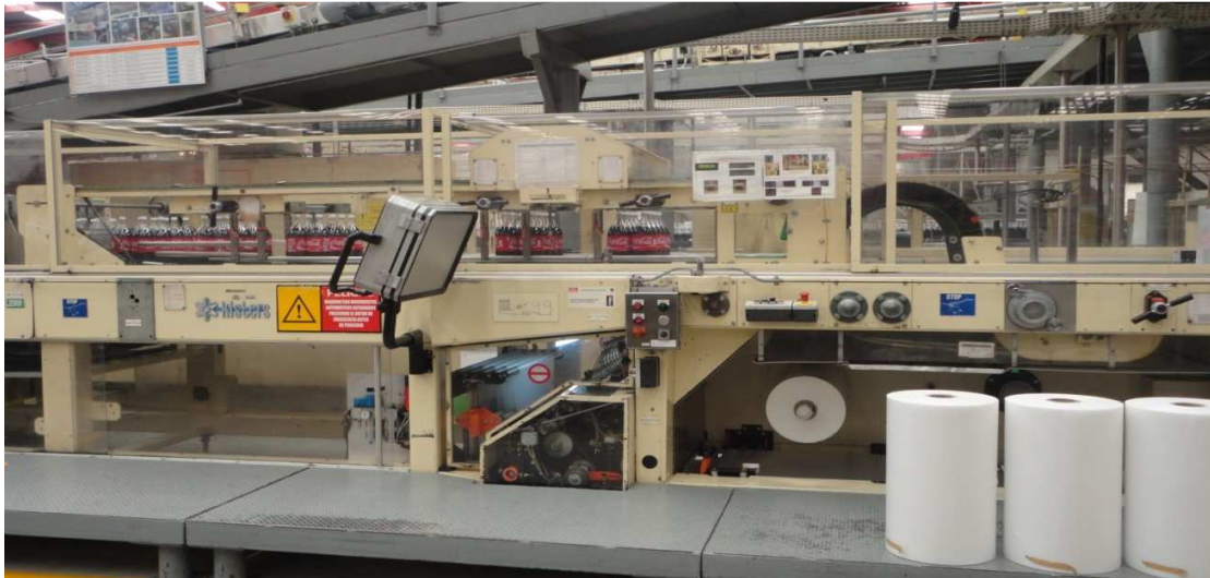
Figura 6) La empacadora de marca KISTERS tiene la capacidad de armar paquetes de 4 botellas en presentaciones de 3 litros.
