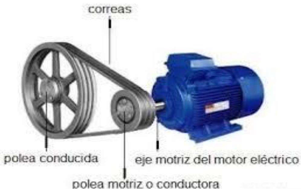
Figura 4.19 Parte e transmisión externa de una bomba
