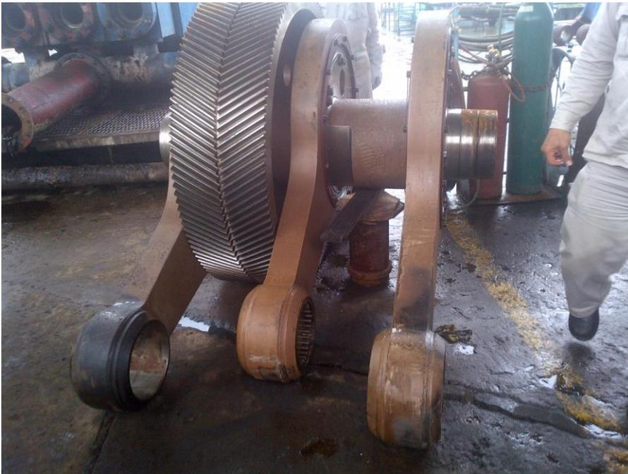
Engrane corona, eje del cigüeñal, bielas y rodamientos de la biela
