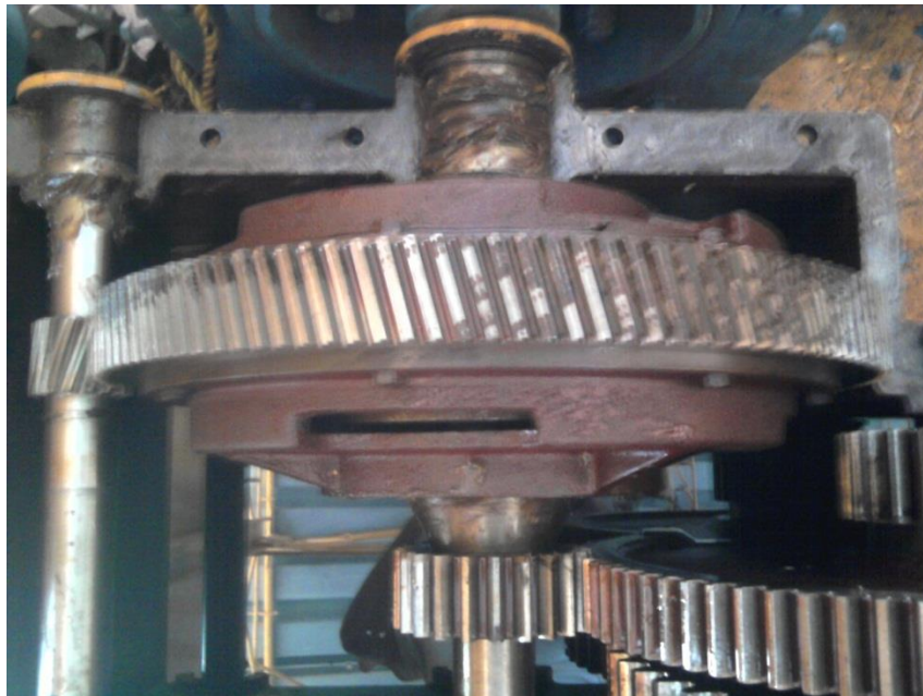
Ilustración 33. Detalle del engranaje planetario. Se observa que este engrana a un piñón semi-helicoidal lo que proporciona el movimiento al engrane anular del sistema.
