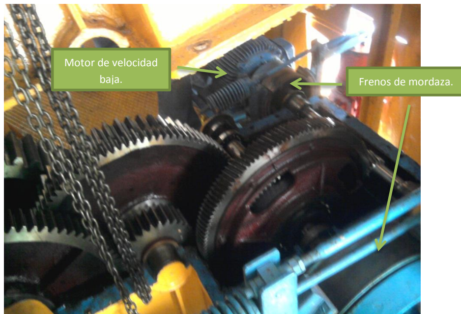
Figura 32. Transmisión mecánica de potencia en grúa pórtico de 90 toneladas. Tal y como se puede apreciar cada motor cuenta con un disco de frenado y sus respectivas mordazas.
