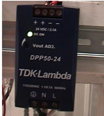
Figura 73. Verificar que el foco de encendido de la fuente de poder este activado.
