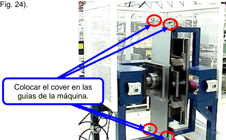
Figura 24. Colocación de placa de cover en las guías de la máquina.
