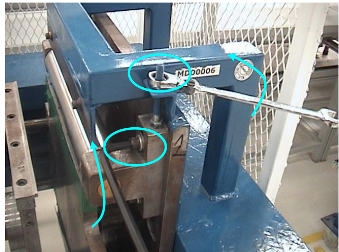
Figura 46. Tornillo y tuerca de sujeción, se aflojan para poder mover los rodillos.
