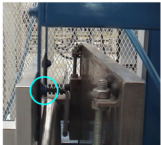
Figura 56. Tornillo de ajuste de guías por la parte trasera.
