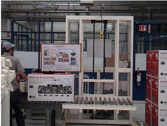
Figura 5. Elevador de Producto Terminado.
