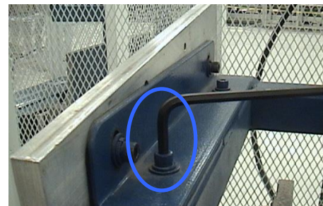
Figura 67. Tornillo para mover la guía completa.
