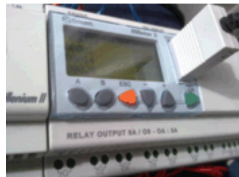
Figura 89. Insertar el cable USB como se indica.
