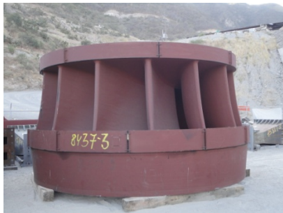
Fig. 3. Rodete de una turbina Francis (La Yesca)
