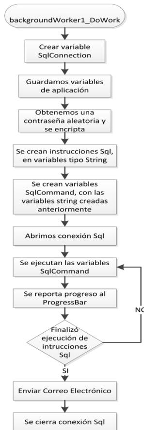
Figura 6: Diagrama de flujo de backgroundWorker1\_DoWork
