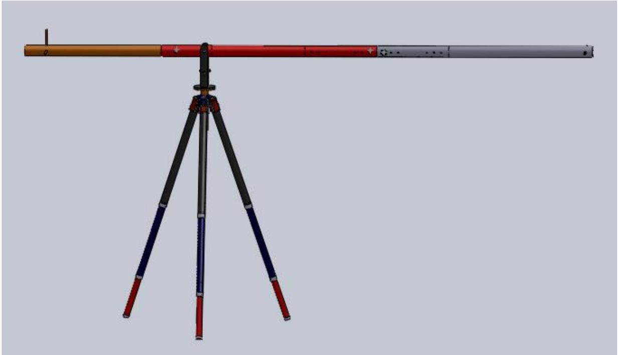
Figura 4.5 Pluma montada en el trípode
