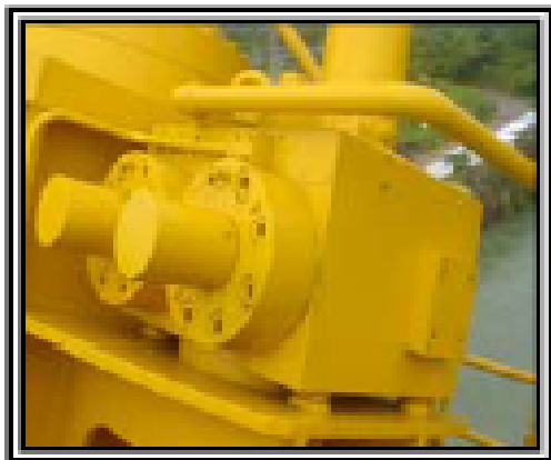
Fig. 4.9 Válvula de freno 46.5 y 46.6 De la 1ra y 2da etapa. Cierre veloz y cierre intermedio
