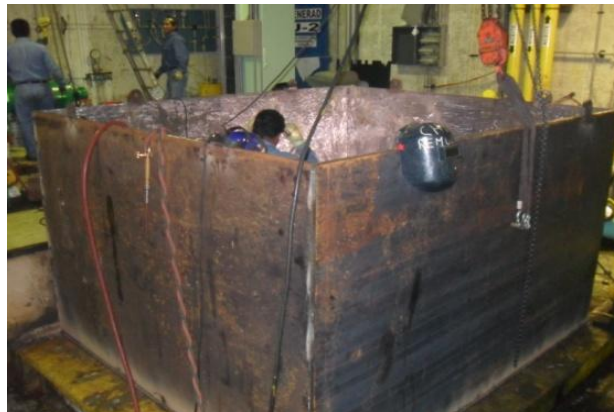
Fig. 3.34 Depósito de aceite vk 300 (tanque de aceite a baja presión)
