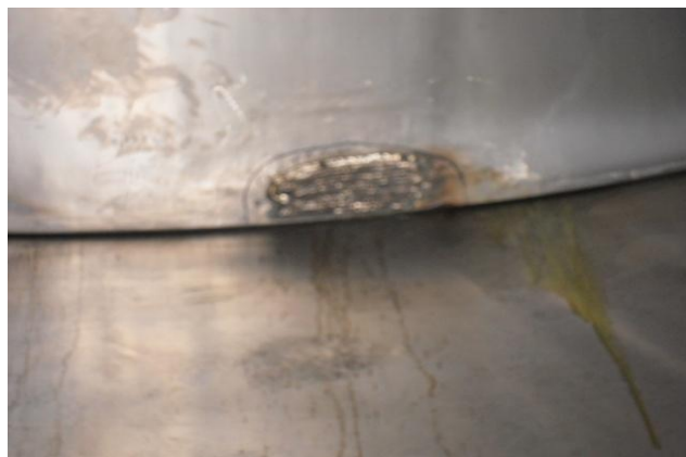
Fig. 3.13 Zona cavitada de los alabes del rodete
