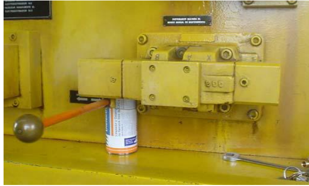
Fig. 4.23 Electro-distribuidor 26.2 para el mando manual de mantenimiento
