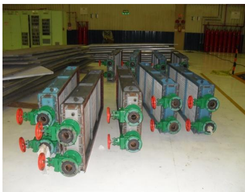
Fig. 3.20 y 3.21 Radiadores y válvulas de alimentación y descarga del enfriamiento
