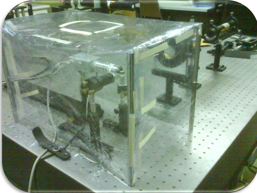
Figura 8.4.4. Caja montada como protección para el micro circuito.
