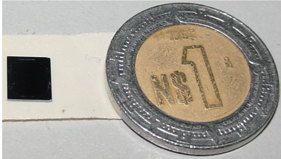
Figura 8.4.7. El micro circuito Óptico Integrado a la izquierda y una moneda común a la derecha.
