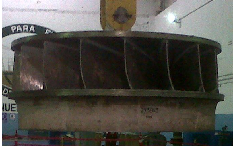
Fig. 1.7 Turbina Hidráulica Mitsubishi.
