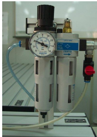
Imagen 2.13 - Unidad de mantenimiento
