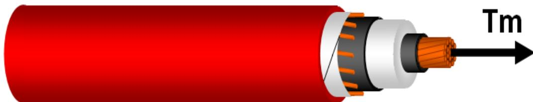
*Fig. 5.12 Tensión de jalado*
