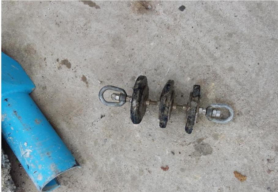
**Fig. 4.16** *Guiadora de ductos*
