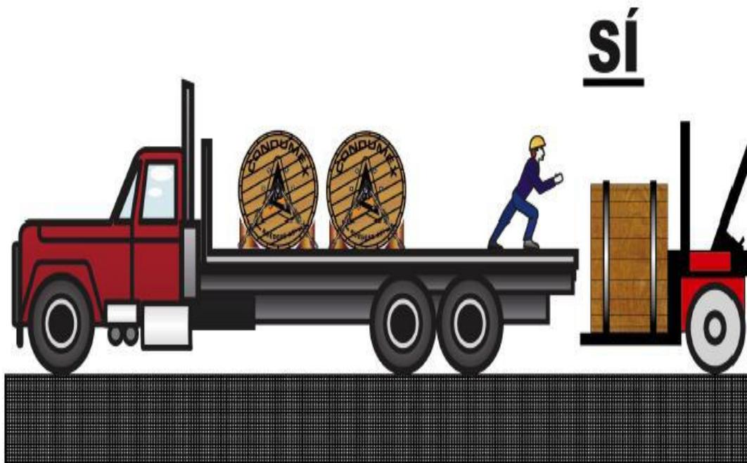
*Fig. 5.2 Forma adecuada de carga y descarga de carretes*
