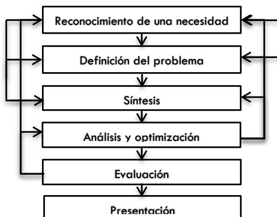
Fig. 2.2 Fases del proceso de diseño, con retroalimentación e iteraciones.
