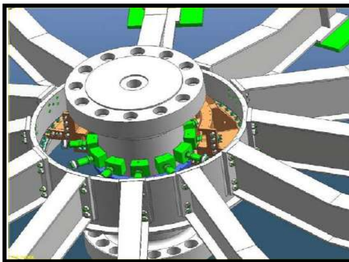
Fig. 20 Estructura de una chumacera guía
