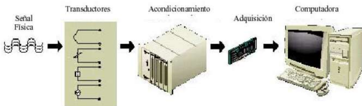
Fig. 24 Sistema de Monitoreo y Control de Vibración en Computadora, a través de una tarjeta de Adquisición de datos, Acondicionamiento de Señal y Transductores
