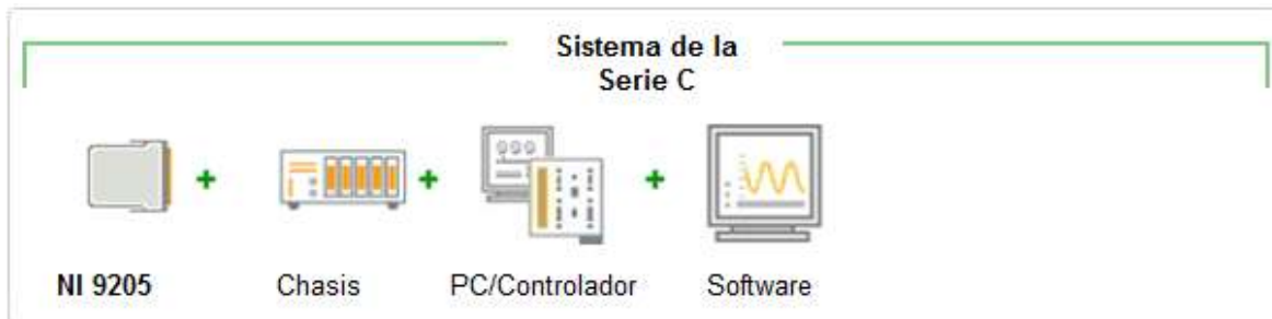
Fig. 36 Componentes del sistema NI-COMPACTDAQ
