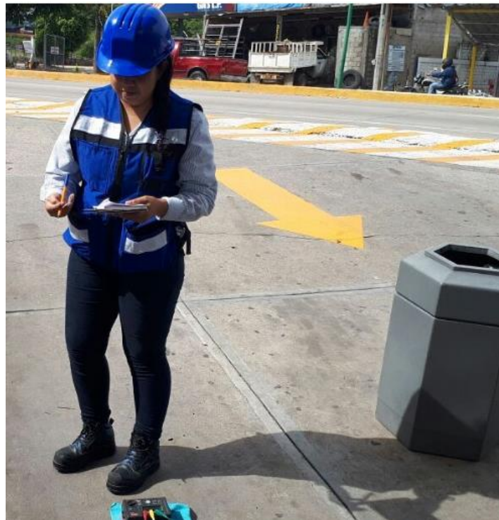
Fig. A3 Medición de tierra electrodo de almacenamiento de combustible o diésel
