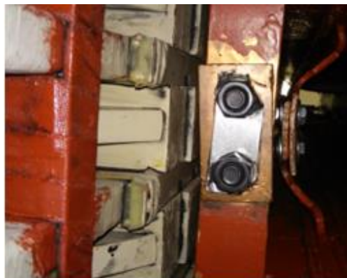
Figura 3.132 Conexión de las barras amortiguadoras
