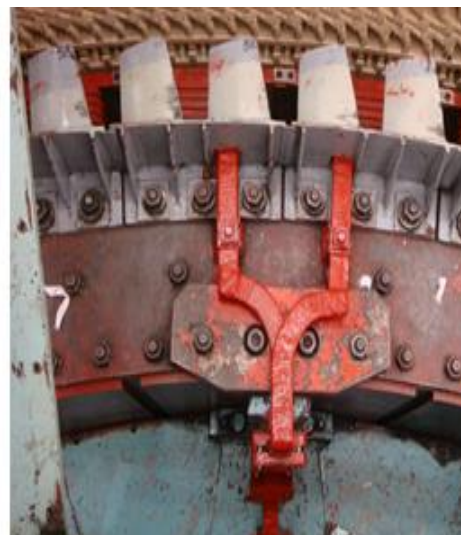
Figura 3.73 Colocación de las barras de excitación
