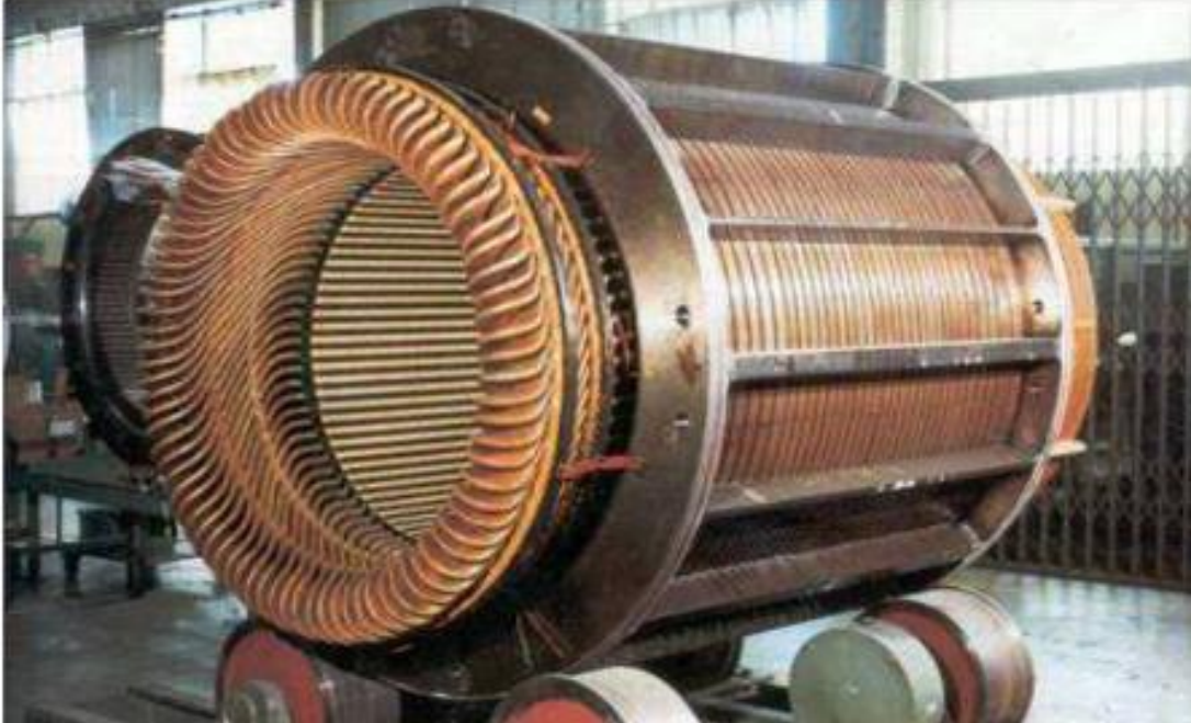
Figura 2.12 Estator, armadura o inducido de un generador o alternador síncrono
