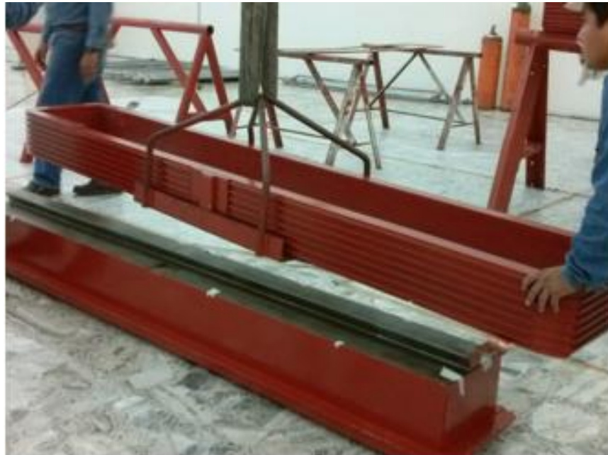
Figura 3.111 Colocación de la bobina al núcleo polar
