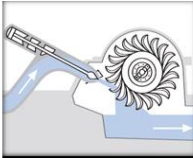
Figura 2.7 La turbina Pelton
