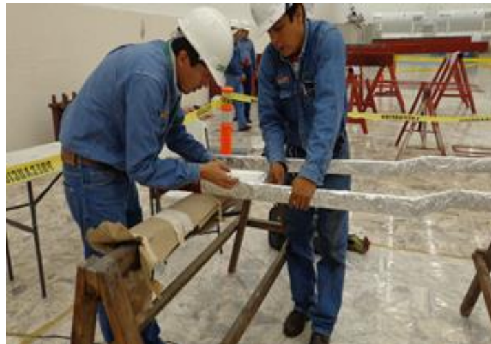
Figura 3.59 Prueba de R.A con las barras envueltas de papel aluminio
