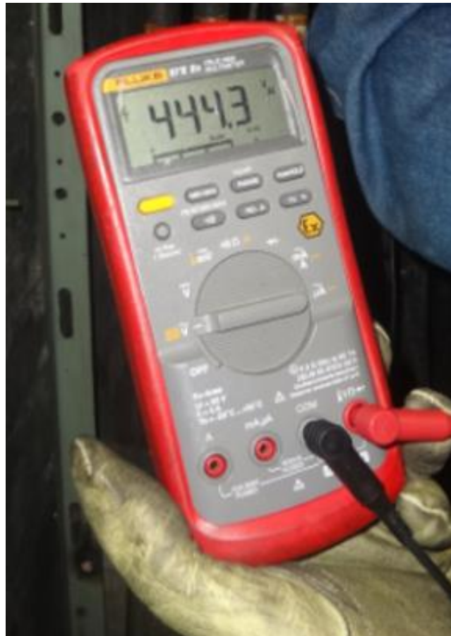
Figura 2.21 Multímetro de verdadero valor eficaz con seguridad intrínseca 87V Ex de Fluke.
