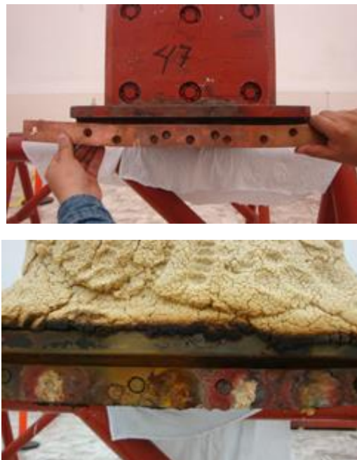
Figura 3.94 Rehabilitación de la barra amortiguadora
