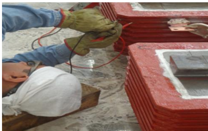
Figura 3.96 Prueba de caída de tensión entre espiras al polo 35
