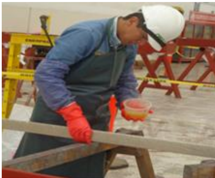
Figura 3.69 Aplicación de la resina epoxica
