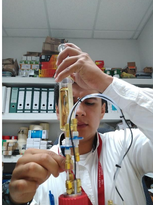
Figura 3.174 Con ayuda de la jeringa se puede sacar la muestra de aceite del Calisto que es un monitoreo en línea para protección del transformador.
