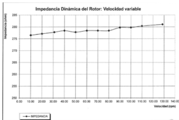
Gráfica 3.8 Prueba de impedancia dinámica a velocidad variable
