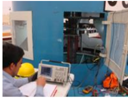
Figura 3.165 Personal de LAPEM realizando prueba de impulso a la frecuencia en baja tensión.
