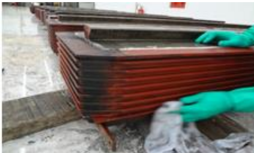
Figura 3.105 Estado de los polos extraídos
