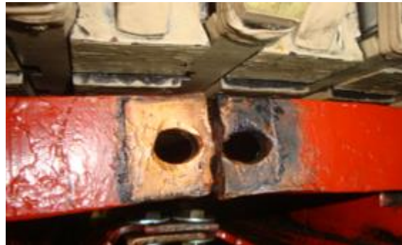
Figura 3.140 Barra amortiguadora en mal estado
