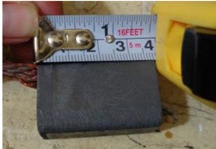
Figura 3.53 Carbón en el límite de su medida 3.6 cm
