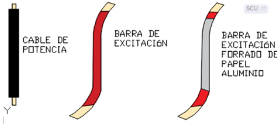
Figura 3.56 Comparación del cable con barra de excitación y barra de excitación forrado con papel aluminio.
