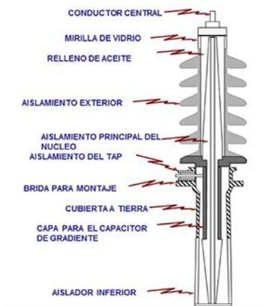
*Fig. 2.3 Partes de una boquilla*
