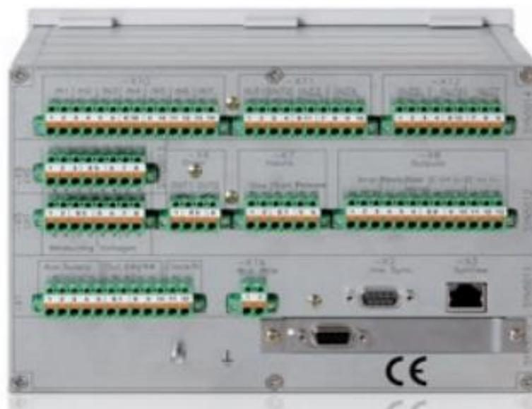
**Figura. 3.16** Las conexiones convencionales se hacen por medio de regletas de contactos
