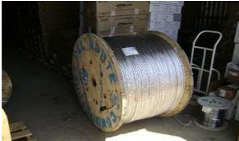
Fig. 3.1.14 se observa el conductor 1/0 AWG O KCM ACSR (cable de aluminio con refuerzo central de acero)
