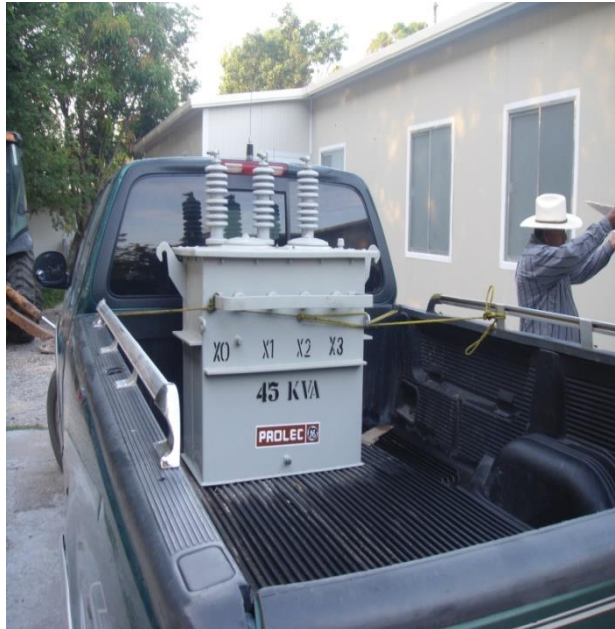
Fig. 3.1.18 Transformador de 45 KVA (PROLEC).
