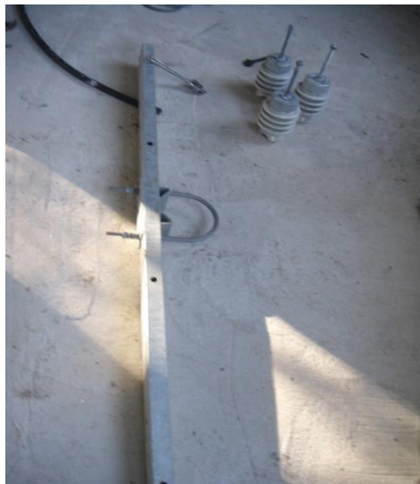
Fig. 3.1.11 la imagen izquierda es una cruceta C4T con aisladores tipo poste 13PC, la imagen de la derecha es un cruceta doble PT200, PT250 con aisladores de suspensión (Asus).
