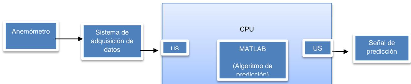
**Figura 1.2** Diagrama del hardware.
