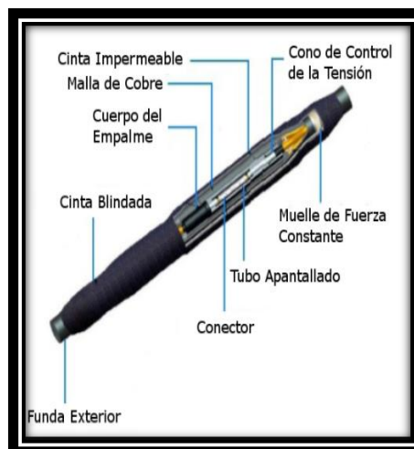
Figura 2.39.- Empalme termocontráctil. Figura 2.40.- Componentes internos.
