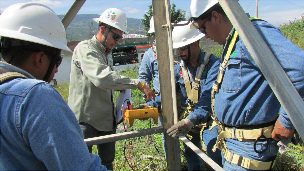
Figura 29. Reiniciar 4 veces la medición en la misma pata en cada una de ellas.
